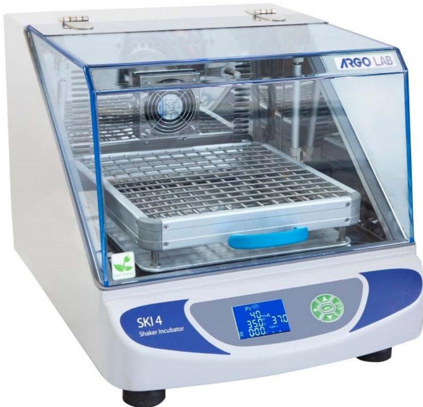
Ampia cupola in Plexiglas dello spessore di 8 mm per una visione ottimale e monitoraggio dello status dei campioni senza alcuna dispersione di calore, dotata di molle a gas per facilitarne l'apertura. Doppio sistema di sicurezza con blocco automatico dell'agitazione e del riscaldamento in caso di apertura cupola con riavvio automatico dopo la chiusura.
